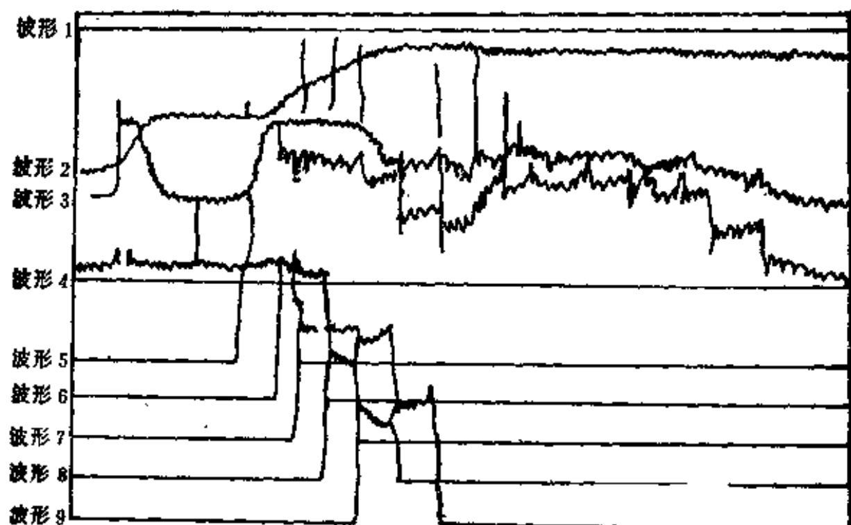
图 4-85 顶管过程测量波形图
