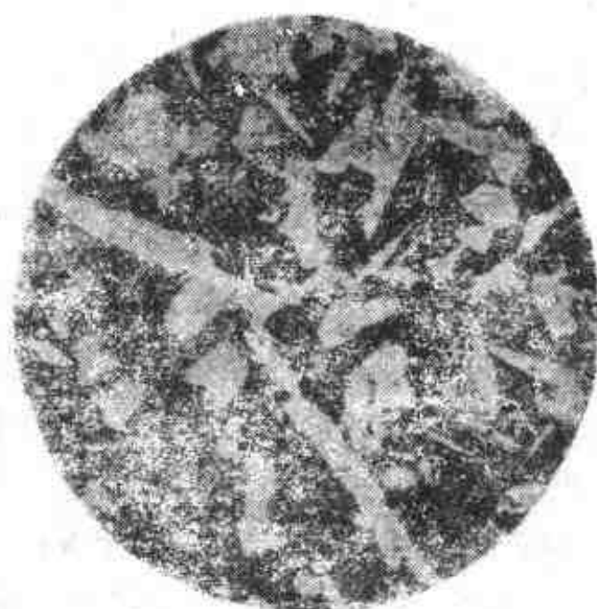
图 2-5 ZG35圆铸坯原始晶粒组织（ \times 100 ，4%硝酸酒精侵蚀）
