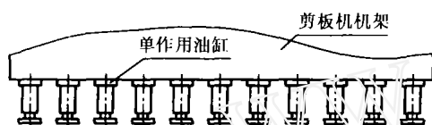
图 1 原剪板机压脚结构
