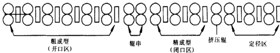
图1 焊管成型机组的组成
