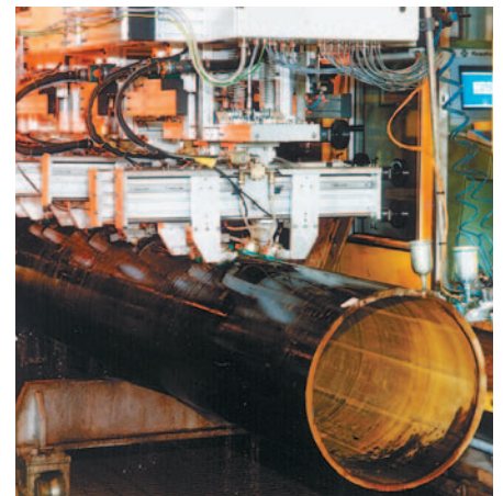
在埋弧纵向焊接钢管上进行焊缝检测
