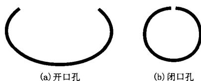
图 11 CBR 成型区带钢横截面图
