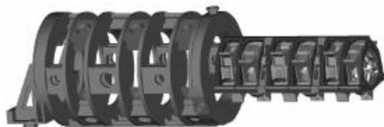
图 2 PQF 三辊连轧管机机架隧道式牌坊示意
